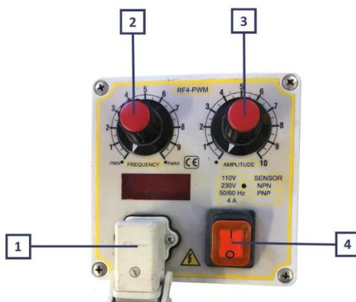
Per rispetto della normativa **EMC** il circuito è dotato di filtro con correnti di perdita verso terra inferiore a 1mA. Il circuito fornisce al vibratore un segnale di comando modulato in larghezza di impulsi (**PWM**) regolabile sia in **Ampiezza** che in **Frequenza**. Tale segnale è compensato nei confronti delle variazioni della tensione di linea.
