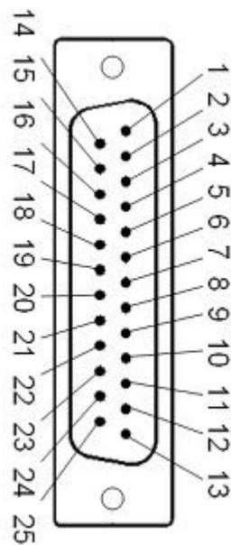
**Nota:** Se è stato acquistato l'illuminatore strobe sarà cura del cliente portare la corretta alimentazione 24Vdc al Pin 16 e 17.
